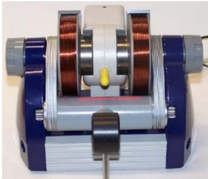
Նկ. 19. Հիմնական միավորը ներմուծված գլիցերինային նմուշով
