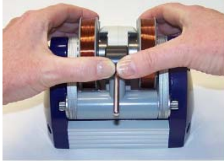
Նկ. 16. Մագնիսական միավորի դուրս բերումը հիմնական միավորից
