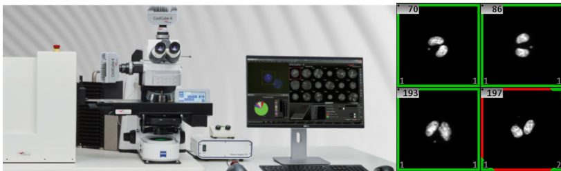
Նկար 102. Metafer համակարգն (ձախ նկար) ու դրա միջոցով ստացված ՄԿ պարունակող բինուկլեատ բջիջների պատկերներ (աջ նկար) ( https://metasystems-international.com/ ):
