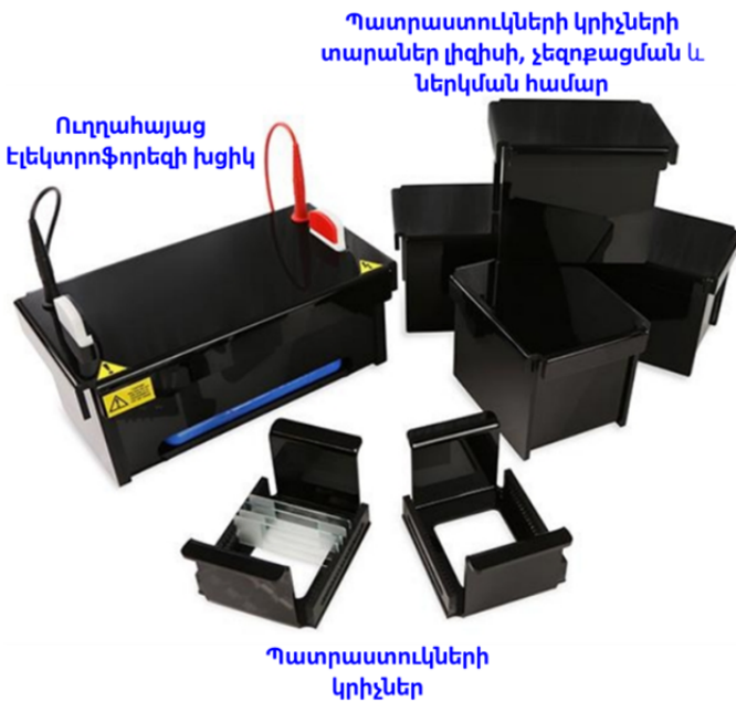
Նկար 104. Բարձր թողունակությամբ ԴՆԹ կոմետ մեթոդի համար կիրառվող պարագաներն ու էլեկտրոֆորեզի խցիկը (Ji et al., 2022):
