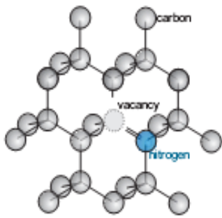
Նկ. 14.7. Ազոտ-վականսիա դեֆեկտը ալմաստի բյուրեղում, դեֆեկտի էներգետիկ մակարդակների սխեման և ֆլուրեսցենցիայի պատկերը (Physics of single quantum emitters, Fig. 170):
